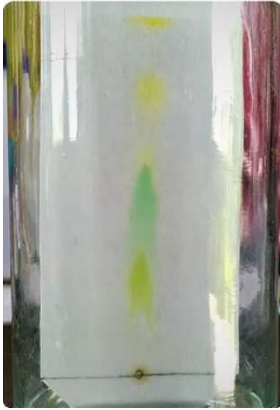
الشكل 33 فصل الأصباغ النباتية على ورق الترشيح
